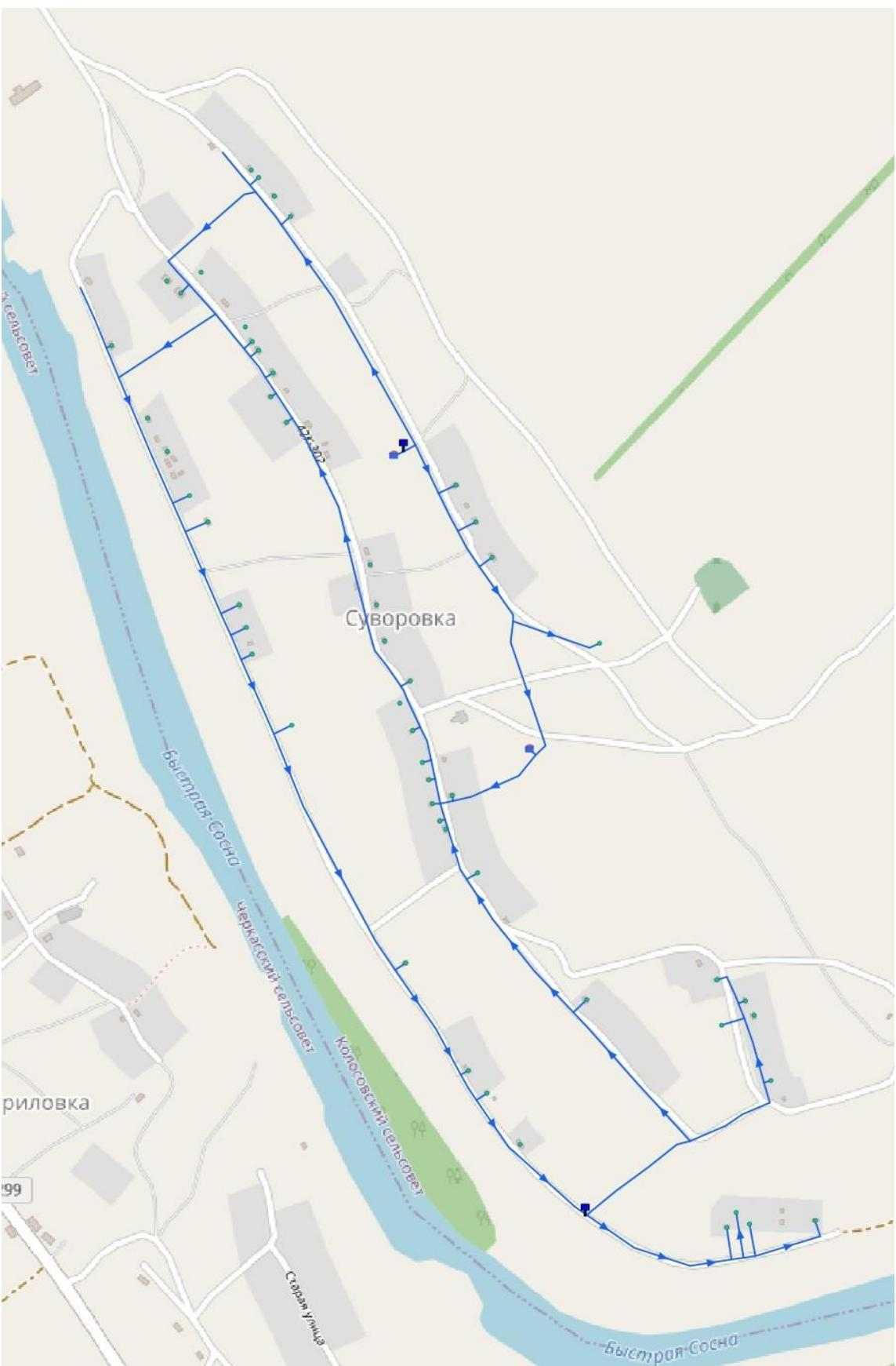
Рисунок 12. Объекты централизованной системы водоснабжения д. Суворовка
