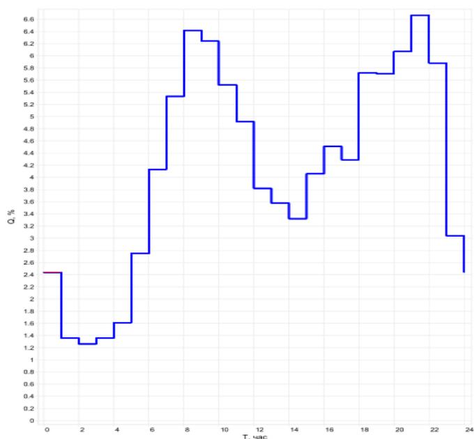
Рисунок 6. Расчетный суточный график водопотребления в районах населенных пунктов с преобладающей жилой застройкой
